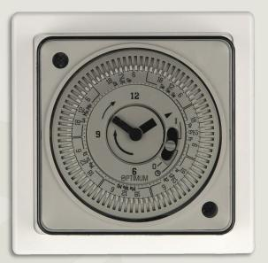
OP-SBSW IS A CAPTIVE-TAPPET 7 DAY TIME SWITCH. EACH TAPPET OPERATES THE OUT-PUT FOR A PERIOD OF 2 HOURS. THE TIMER IS SUITABLE FOR INSTALLATION ON A SURFACE OR IN-WALL PATTRESS BOX. THE 7 DAY DIAL CONTROLS A VOLT-FREE CHANGEOVER SWITCH, WITH A RESISTIVE RATING OF 16 AMPERES.
